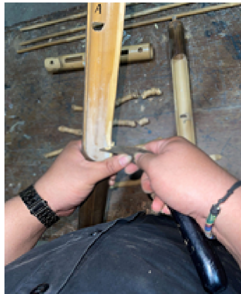
Gambar 5: Proses Ngaraut untuk Merendahkan Nada ( tuning ) (Sumber: Dokumentasi Gigin, 2023)
