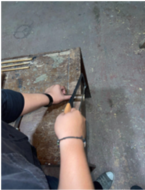
Gambar 6: Proses Pemotongan Guluntung untuk Meningkatkan Nada ( tuning ) (Sumber: Dokumentasi Gigin, 2023)
