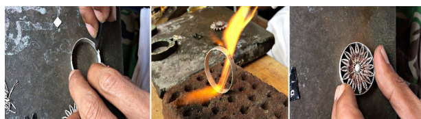
Gambar 80. a. Pembuatan Lingkaran Perak
