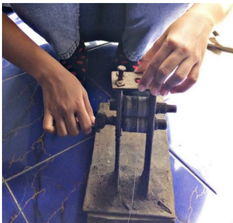
Gambar 77. Cara Pembuatan pilinan Benang Perak Untuk Isian Pola (Foto: Achmad Sungkar, Juli 2017)
