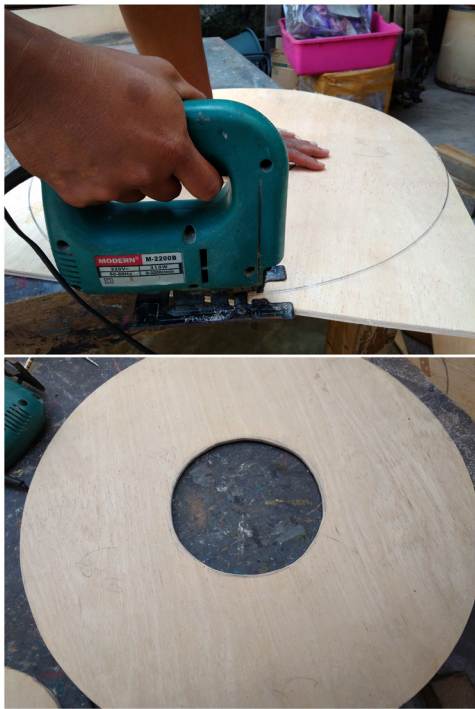
Proses pemotongan papan kayu (foto: tohari)
