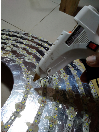
Pembentukan lengkung lampu dengan glue gun (foto: tohari)
