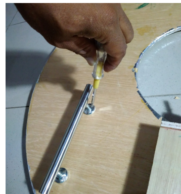
Pemasangan handle pada lampu (foto: tohari)
