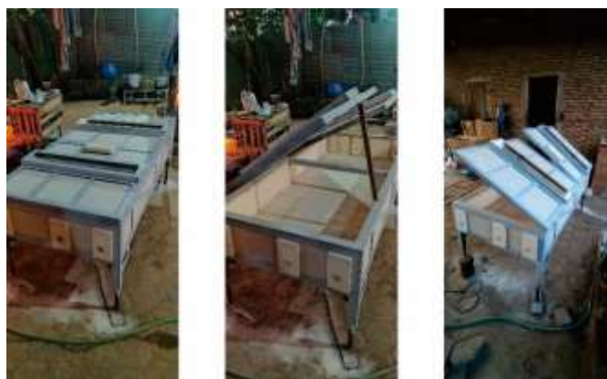
Gambar 2. Pembuatan dan penyempurnaan tungku peleburan kaca (Fika Fiqroni, 2024)
