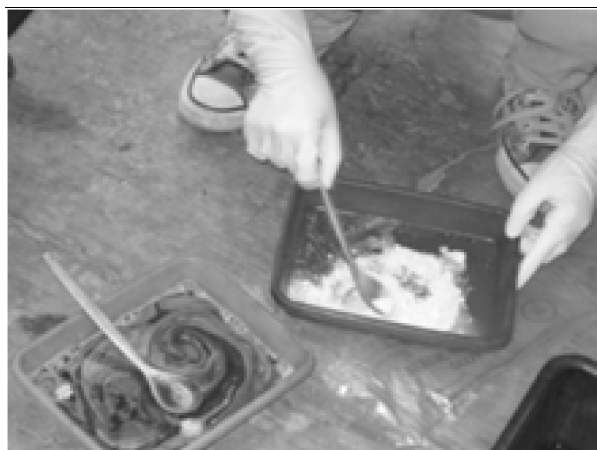
Gambar 6. Pelaksana kegiatan workshop dibantu mahasiswa Jurusan Kriya FSRD ISI Surakarta menyiapkan pewarna batik sintetis (naphthol + garam diazo) untuk melaksanakan proses pewarnaan/ pencelupan warna.
