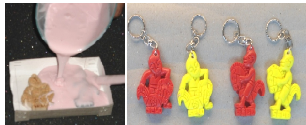
Foto 8. Model bentuk Jaran Kepang direkatkan pada kotak kertas yang sedang dituang Silicon Rubber, dan hasil cetakan Resin dengan warna merah dan kuning.
