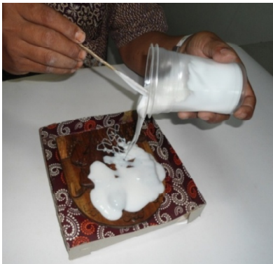
Foto 11. Menuang campuran Silikon+ pengeras di atas relief.
