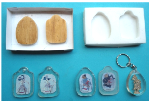
Foto 10. Model ditempel pada kotak siap dituang Silikon Rubber; Hasil cetakan dari Silikon (putih); Hasil cetak Resin Bening dengan foto wayang Purwa di dalamnya.
