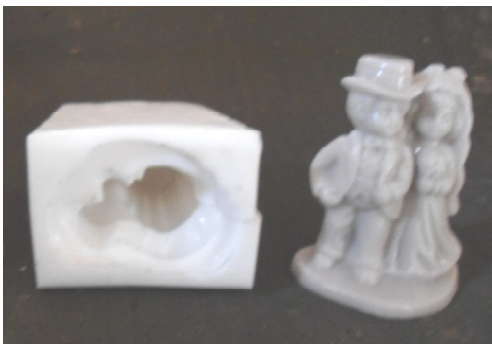
Foto 20. Cetakan silikon tampak bawah, dan hasil cetakan patung ‘Temanten’ dari resin+ talk.
