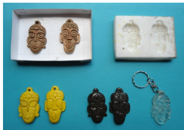
Foto 9. Model Topeng untuk Gantungan Kunci ditempel pada kotak kertas; Hasil cetakan dari Silicon; dan Hasil cetak Resin dicampur talk + sandy kuning, dicampur pasir (jadi hitam), dan resin bening.
