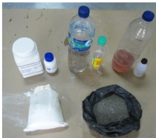
Foto 7. Bahan untuk cetak: Silikon, Resin Bening dan Butek, katalis, talk, dan pasir halus.
