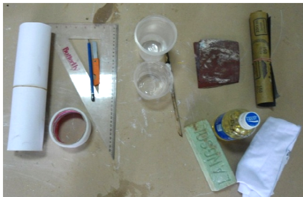
Foto 6. Peralatan untuk cetak resin: kertas, potlot, penggaris, kate, solatif bolak-balik, wadah untuk mencampur silicon/ resin, amblas dan alat pengkilap (batu Langsol, bensin & gombal)
