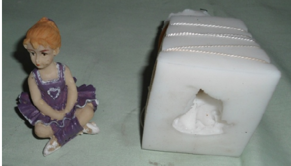
Foto 18. Model patung “Gadis” dan hasil cetakan silikon yang diikat dengan tali mengelilingi cetakan, siap untuk dituang dengan resin + katalis + talk + pewarna.
