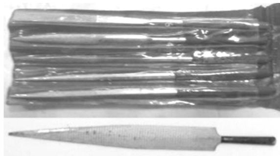
Gambar 2. Kikir dengan berbagai bentuk dan ukuran.
