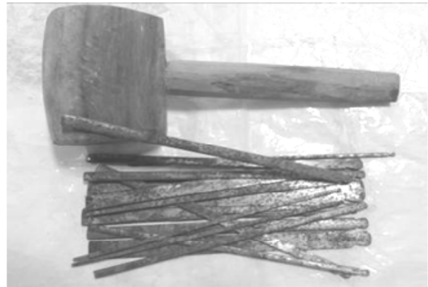
Gambar 1. Tatah ukir dengan berbagai ukuran dan palu, Foto Amir Gozali 2016.
