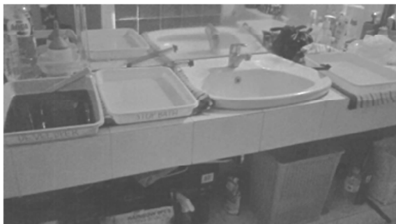
Gambar 9. Suasana kamar gelap basah dengan susunan developer-stop bath dan fixer secara berurutan. (Foto oleh: Anin Astiti)
