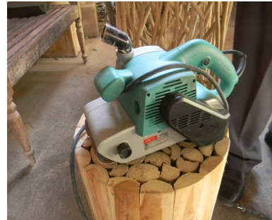
Gambar 16. Belt Sender untuk menghaluskan meja (Dok. Penulis)
