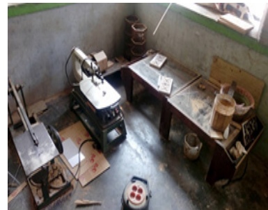
Gambar 17. Scoll Saw untuk memotong bahan kerajinan kayu (Dok. Penulis)
