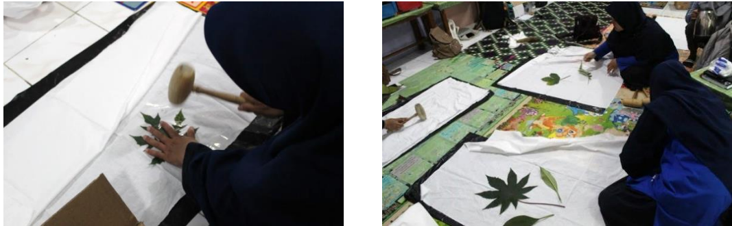
Gambar 4. Proses pounding , pembuatan asesoris interior dengan teknik ecoprint (Foto oleh: Ayu Ratna)
