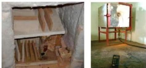
Setelah kering kemudian semua lempeng tes dimasukkan ke dalam tungku pembakaran untuk dilakukan bakar pertama yakni bakar biskuit dengan suhu bakar 800°C dengan cara bakar oksidasi, pembakaran lempeng keramik dengan menggunakan alat pantau suhu termokoupele untuk memantau kenaikan suhu.
