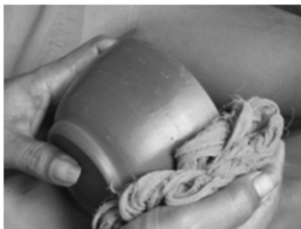
Gambar 12. Proses ngerol yang diganti dengan menggunakan kain klambu yang terbuat dari plastik sintesis Lokasi rumah Bapak Andono, pengrajin Foto: Prima Yustana, 2013
