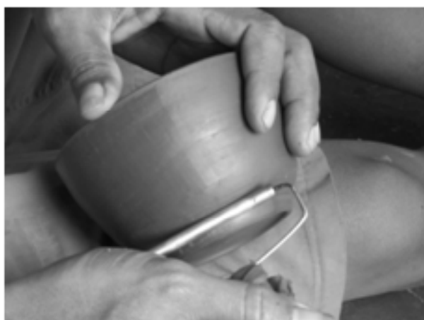
Gambar 11. Proses ngerol dengan menggunakan alat bantu yang terbuat dari logam yang dibentuk seperti penggilas kecil yang dapat berputar. Lokasi rumah Bapak Andono, pengrajin Foto: Prima Yustana, 2013
