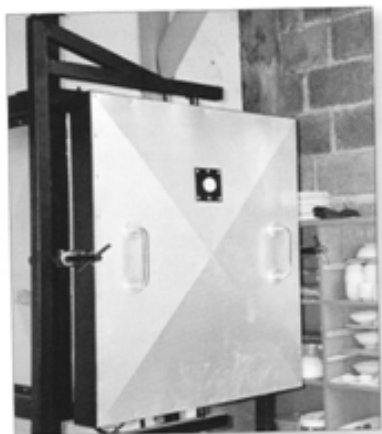
Gambar 57. Jenis oven gas untuk pembakaran keramik Sumber : Nia Gautama, Keramik Untuk Hobi Dan Karir 2011, p. 85
