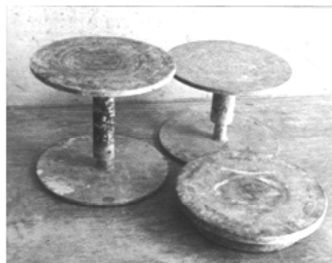
Gambar 55. Alat Bantu Putar untuk pembentukan keramik Foto: Nia Gautama, Keramik Untuk Hobi Dan Karir 2011, p. 29
