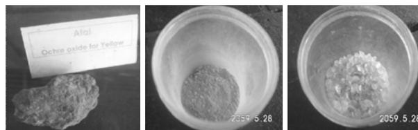
Gambar 9. Contoh salah satu pewarna alami yang digunakan berupa *Atal* yang masih berupa batu untuk bahan warna kuning dan *Atal* yang sudah ditumbuk halus, serta *Ancur* sebagai bahan perekat warna.
