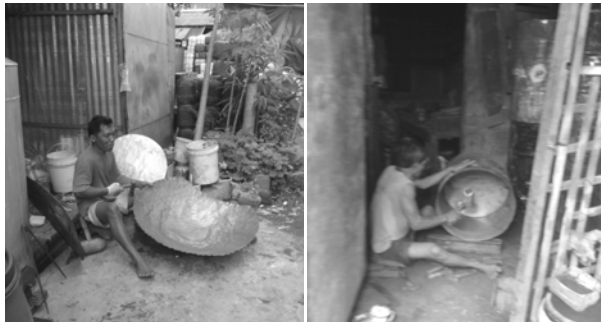
Gambar 8. Proses pembentukan menggunakan palu dari besi (kiri) dan proses penghalusan menggunakan palu dari kayu (kanan).
