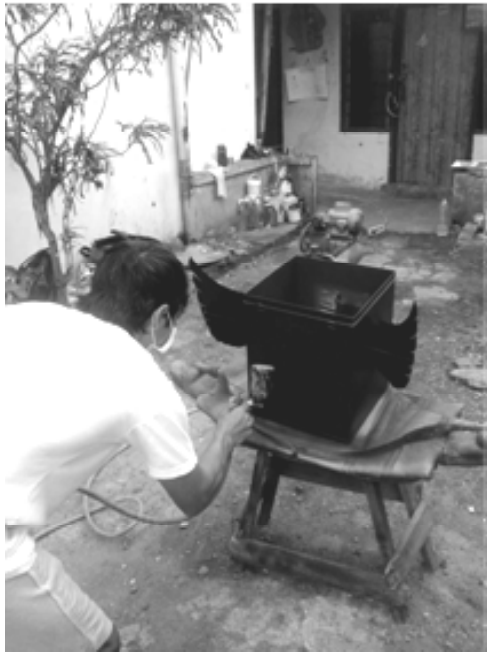
Gambar 15. Proses penyemprotan dengan menggunakan air brush.
