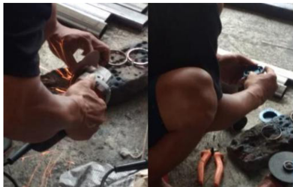
Gambar 10. Membuat Ring dudukan Roll Tangki Pewarna
