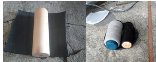
Gambar 7. Pelapisan Roll Kayu dengan Bahan Spon Ati
