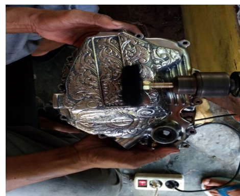
Gambar 27. Proses poles pada permukaan blok mesin.
