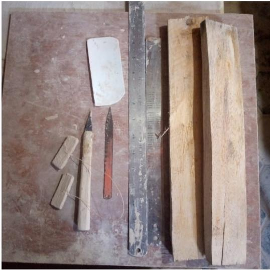
Gambar 22 Peralatan teknik slab terdiri dari papan ketebalan, penggaris, senar, pisau custom, dan sudip
