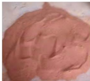
Gambar 3 Tanah liat yang sudah disaring dengan ayakan 50 mess
