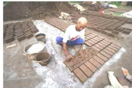
Gambar 1. Seorang pengrajin batu bata di Kec. Mojolaban, Kab. Karanganyar Jawa Tengah sedang mencetak batu bata dengan cara tradisional
