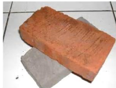
Gambar 6. Bata uji coba dengan bahan eatherware sebelum dan sesudah dibakar
