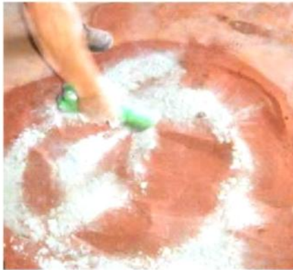
Gambar 4 Penyampuran tepung tanah liat dengan bahan kaolin
