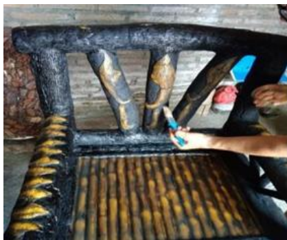
Gambar 13. Teknik finishing mengulas melamin clear pada ukiran aluminium clay sintetik. Menggunakan teknik kuas dan teknik semprot
