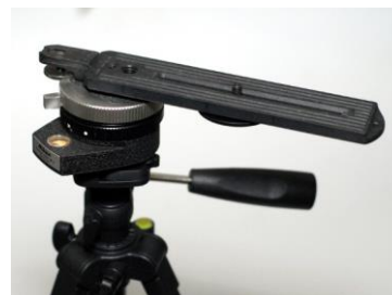
Gambar 7. Pemanfaatan alat alternatif dengan memanfaatkan alat yang telah ada untuk membuat fotografi panorama dengan perspektif 360° (Foto: Jauhari, 2010).
