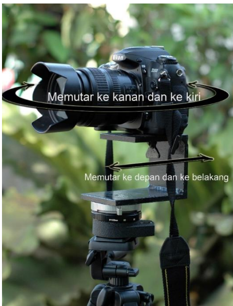
Gambar 9. Proses mencari titik api lensa dengan memutar panorama head agar diperoleh gambar yang presisi (Foto: Jauhari, 2010).
