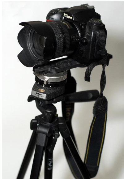
Gambar 8. Pemanfaatan alat alternatif dengan memanfaatkan alat yang telah ada untuk membuat fotografi panorama dengan perspektif 360° (Foto: Jauhari, 2010).
