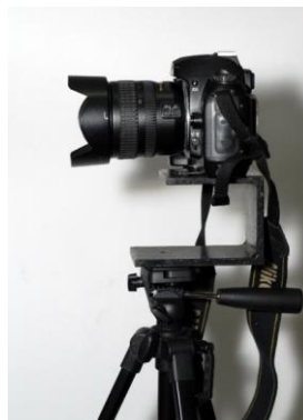
Gambar 6. Pemanfaatan alat alternatif buatan Ranang AS untuk membuat fotografi panorama dengan perspektif 360° (Foto: Jauhari, 2010).
