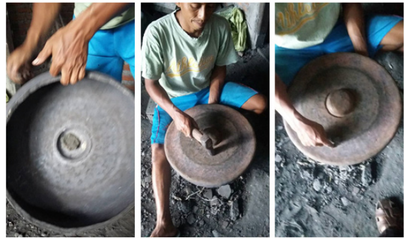
Gambar 7. Kiri Tanah liat ditempel di pencu, tengah tempat yang dipukul, kanan tempat yang ditempel tanah liat dan dipukul.
