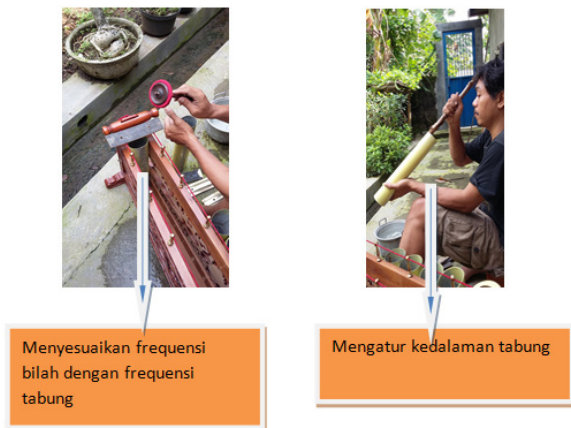
Gambar 3. Kiri Menyesuaikan frekuensi bilah dengan tabung, kanan mengatur kedalaman tabung
