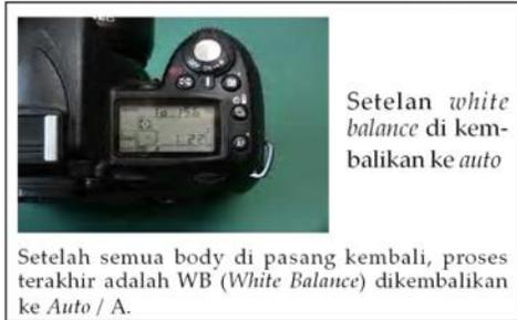
**Gambar 12.** Proses terakhir menataWB (*White Balance*) dikembalikan ke *Auto / A*. (Foto: Arif, 2010)
