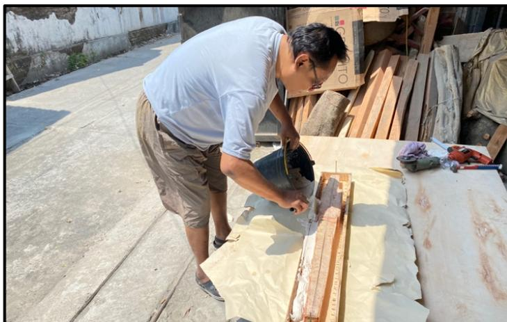
Gambar 9. Pembuatan Kotak Pembungkus Cetakan Negatif pada Bentuk III
