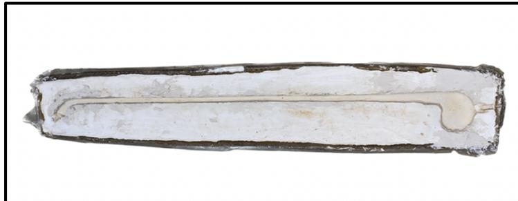
Gambar 7. Cetakan Negatif untuk *Senggrenng* Produksi Tahun 2023
