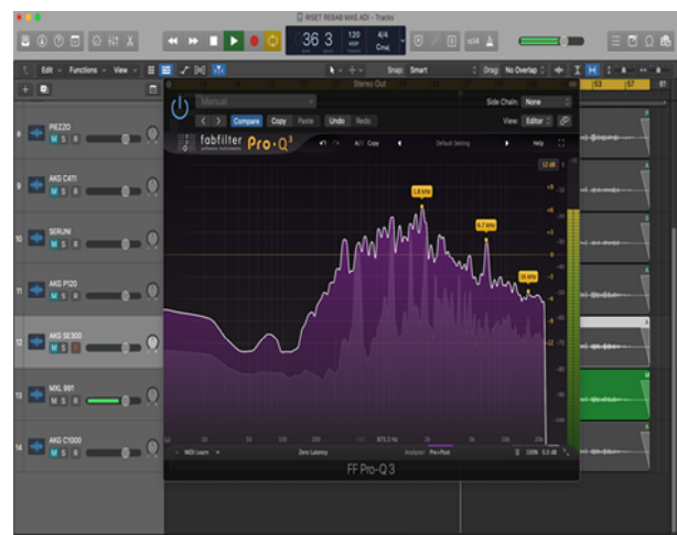
Gambar 6. Respon frekuensi mikrofon MXL 991
