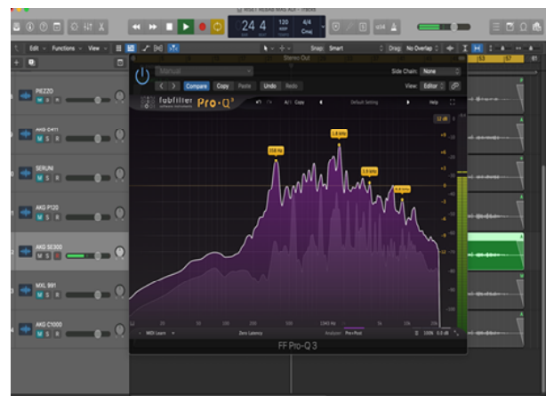
Gambar 5. Respon frekuensi mikrofon AKG SE300
