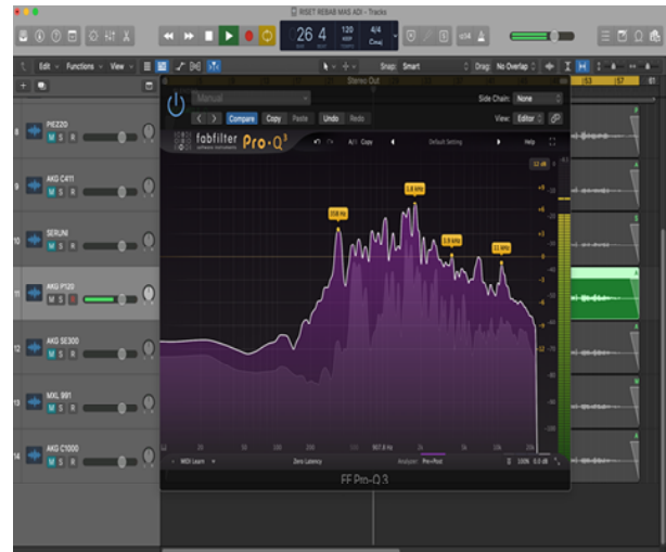
Gambar 4. Respon frekuensi mikrofon AKG C1000
