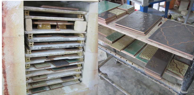
Gambar 5. Posisi keramik dinding di dalam tungku pembakaran dan siap dikeluarkan (kiri) dan hasil jadi keramik dinding dengan berbagai ukuran setelah dikeluarkan dari tungku pembakaran (kanan).
