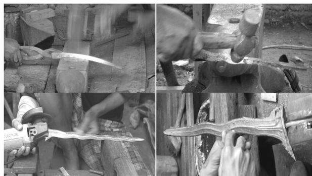
Gambar 2: Proses membuat keris mulai dari bakalan hingga membentuk (*mangun*). (Foto: Kuntadi WD 2010)
