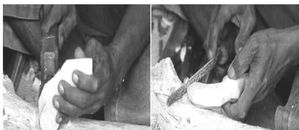
Gambar 3: Proses membentuk dengan petél (kiri), Proses merapikan bentuk dengan patar (kanan) ( Foto Kuntadi WD 2011 )
