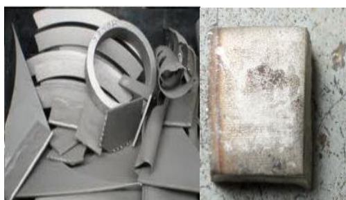
Gambar 5 Bahan baku logam monel dari logam rongsokan dan produknya (Foto: Izza, 3 juli 2015)
