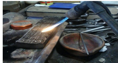
Gambar: Proses pematrian butiran-butiran logam kuningan (Foto dan scan: Ari Harmawan: 10/12/2018)
