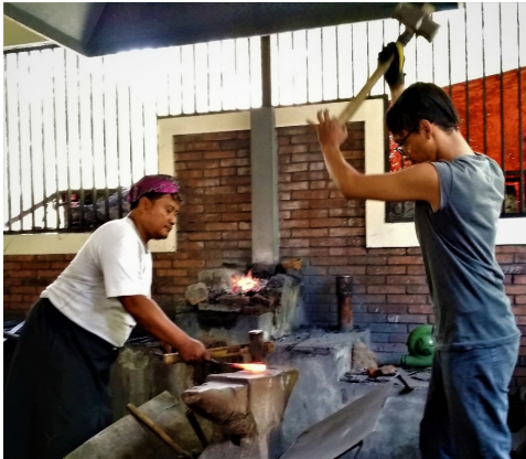
Gambar: Proses membentuk bagian bawah kodokan bilah keris (Foto dan scan: Ari Harmawan: 11/10/2018)
