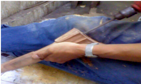
Gambar: Proses nyegrek atau melubangi pada warangka (Foto dan scan: Ari Harmawan: 21/12/2018)
