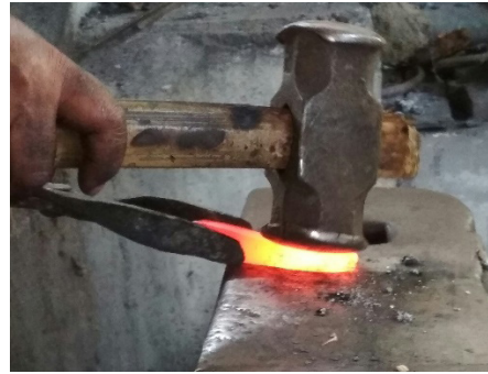
Gambar: Proses penempaan ganja (Foto dan scan: Ari Harmawan: 11/10/2018)
