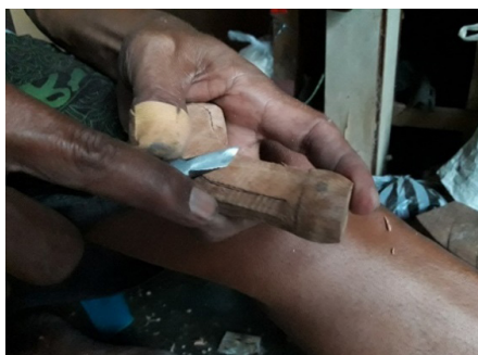
Gambar: Proses merapikan bentuk hulu (Foto dan scan: Ari Harmawan: 18/12/2018)
