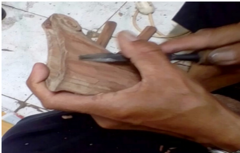
Gambar: Proses membentuk bagian atas pada warangka (Foto dan scan: Ari Harmawan: 22/12/2018)
