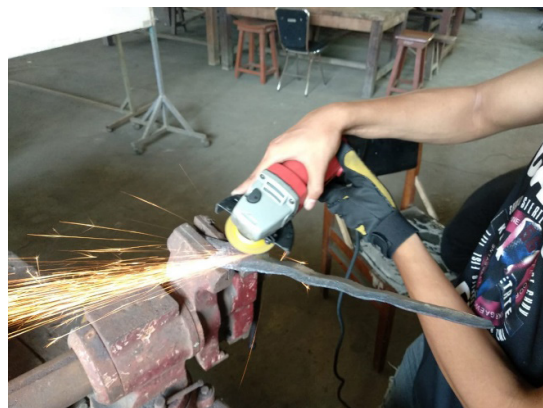
Gambar: Proses membersihkan permukaan bilah keris (Foto dan scan: Ari Harmawan: 15/10/2018)
