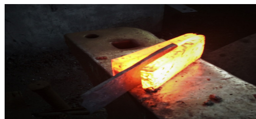
Gambar: Proses penyisipan bahan baja (Foto dan scan: Ari Harmawan: 11/10/2018)
