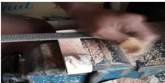
Gambar: Proses membentuk hulu (Foto dan scan: Ari Harmawan: 18/12/2018)
