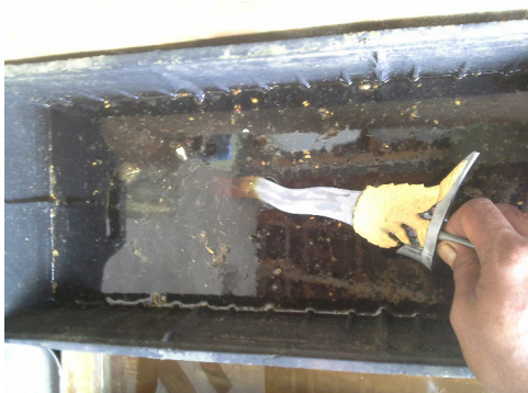
Gambar: Proses ngamal membuka pori-pori pada bilah keris (Foto dan scan: Ari Harmawan: 27/12/2018)
