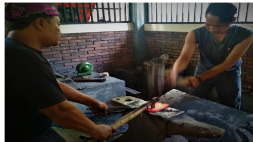
Gambar: Proses pemotongan bahan bilah keris (Foto dan scan: Ari Harmawan: 11/10/2018)
