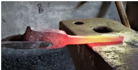
Gambar : Proses membentuk kodokan bilah keris (Foto dan scan: Ari Harmawan: 11/10/2018)
