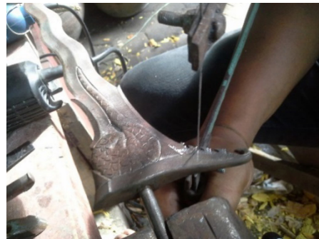
Gambar: Proses membuat greneng pada ganja (Foto dan scan: Ari Harmawan: 23/10/2018)
