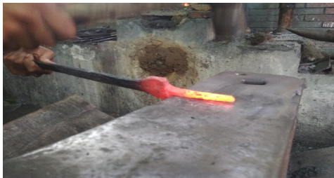
Gambar: Proses membentuk pesi bilah keris (Foto dan scan: Ari Harmawan: 11/10/2018)
