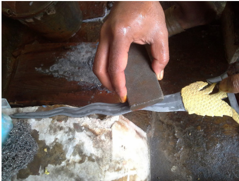
Gambar 109: Proses nyangkling pada permukaan bilah keris (Foto dan scan: Ari Harmawan: 27/12/2018)
