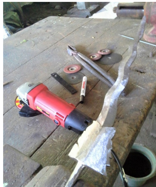
Gambar: Proses pembentukan bilah keris (Foto dan scan: Ari Harmawan: 15/10/2018)
