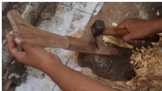
Gambar 23: Proses membentuk bagian bawah pada *warangka*
