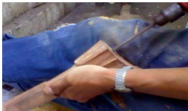
Gambar 24: Proses *nyegrek* atau melubangi pada *warangka*
