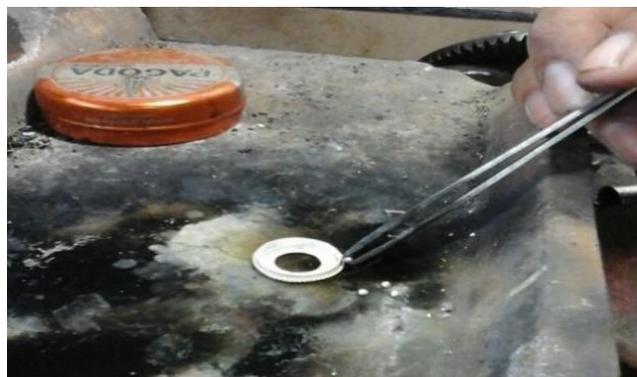
Gambar 17: Proses pemasangan butiran logam
