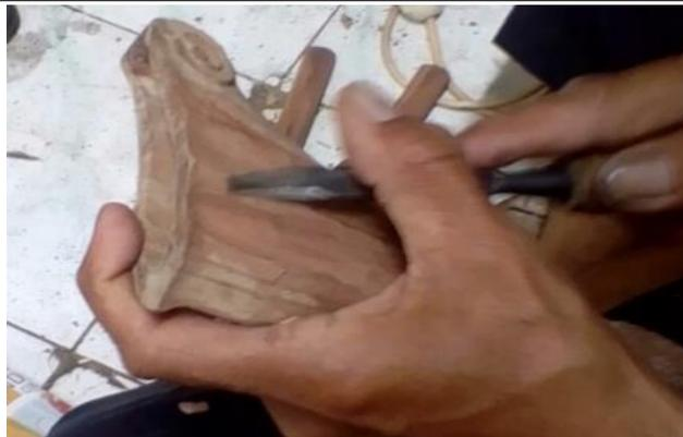
Gambar 25: Proses membentuk bagian atas pada *warangka*
