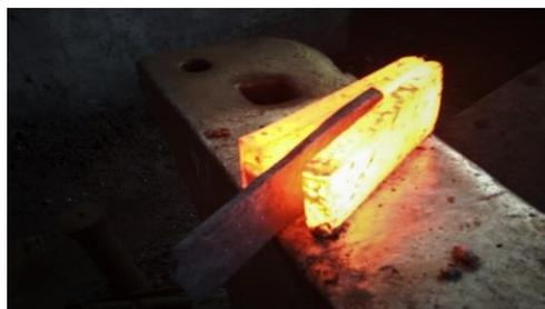
Gambar 2: Proses penyisipan bahan baja
