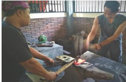
Gambar 1: Proses pemotongan bahan bilah keris
