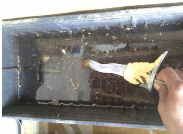
Gambar 15: Proses *ngamal* membuka pori-pori pada bilah keris
