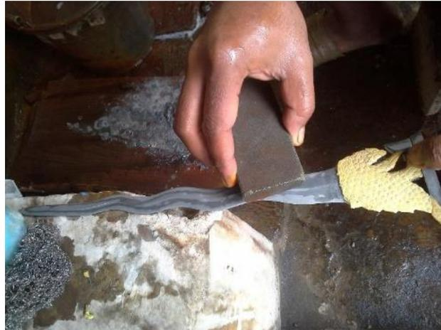
Gambar 14: Proses *nyangkling* pada permukaan bilah keris
