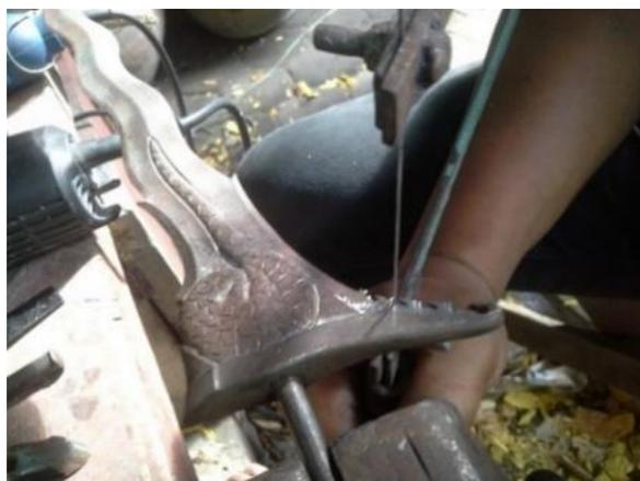
Gambar 13: Proses membuat *greneng* pada *ganja*
