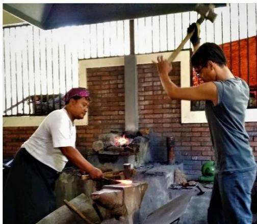
Gambar 3: Proses membentuk bagian bawah *kodokan* bilah keris
