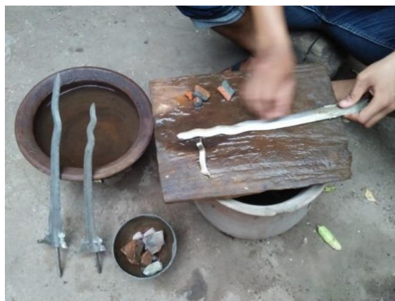
Gambar 6: Proses nyangling / penghalusan bilah dengan batu asah (Dokumentasi: Luky Sutyawan, 2019)
