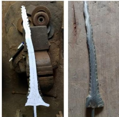
Gambar 2: (Kiri) proses pembentukan bakalan sesuai dengan bentuk blak, (kanan) proses penataan motif pamor (Dokumentasi: Luky Sutyan, 2017)
