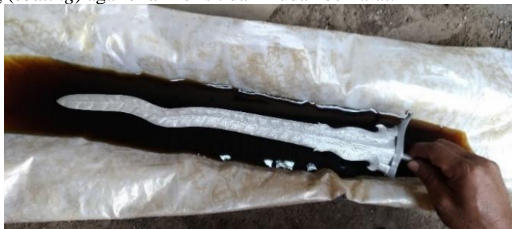
Gambar 8: Proses perendaman bilah keris ke dalam larutan warangan (Dokumentasi: Luky Sutyan, 2019)
