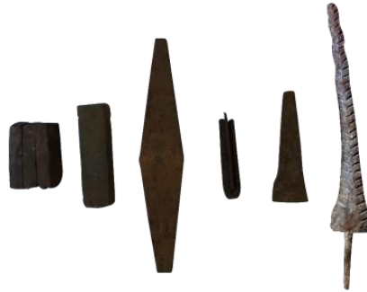
Gambar 1: Urutan proses penempaan bilah keris mulai dari bahan, menjadi saton (calon pamor), kodokan (disisipkan baja), hingga bakalan (calon keris) yang siap untuk lanjut ke proses pembentukan (Dokumentasi: Luky Sutyan, 2017)
