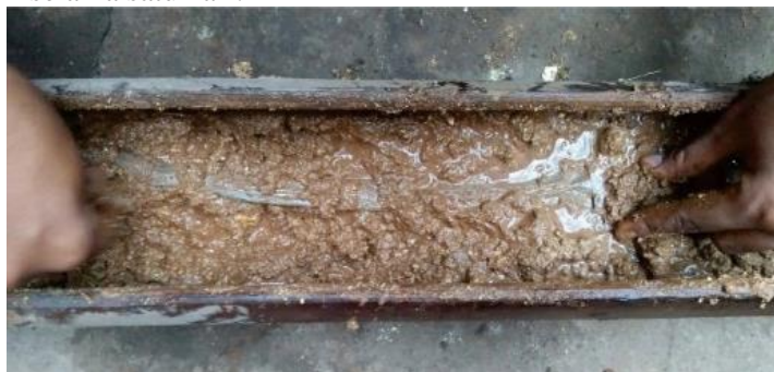
Gambar 7: Proses ngamal atau membuka pori-pori bilah keris (Dokumentasi: Luky Sutyan, 2019)
