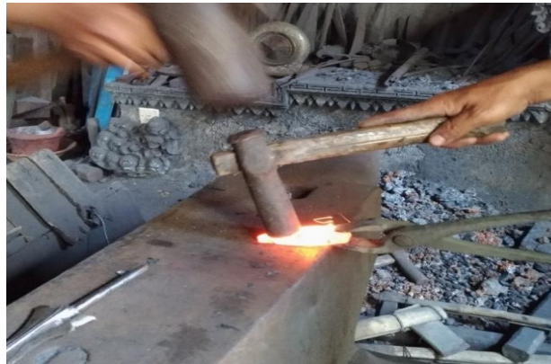
Gambar 4: Pembentukan ganja dengan proses penempaan. Ganja dibuat setelah bilah keris selesai karena menyesuaikan ukuran dan bentuk bilah keris (Dokumentasi: Luky Sutyawan, 2017)
