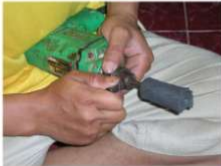
Langkah VIII Pemasangan mata bor pada mesin bor. Peraga: Bagus Indrayana Foto: Sapto A.K
