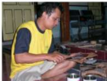
Gambar II Pemberian lem pada papan kayu yang sudah dipotong. Peraga: Bagus Indrayana Foto: Sapto A.K.
