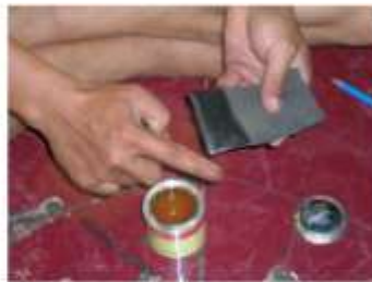
Langkah IV Pemberian lem merek Aibon pada busa. Peraga: Bagus Indrayana Foto: Sapto A.K.
