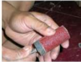
Langkah XIII Model amplas yang sudah siap untuk dipakai. Foto: Septo A.K
