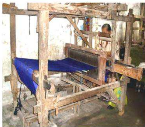
Gambar 5. Seperangkat Alat Tenun Bukan Mesin (ATBM) yang sedang digunakan untuk menenun. (Dok : Joko Budiwiyanto,2011)
