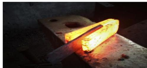
**Gambar 2.** Proses penyisipan bahan baja
