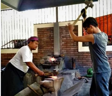
**Gambar 3.** Proses membentuk bagian bawah *kodokan* bilah keris (Foto dan scan: Ari Harmawan: 11/10/2018)
