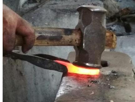
**Gambar 11.** Proses penempaan *ganja* (Foto dan scan: Ari Harmawan: 11/10/2018)
