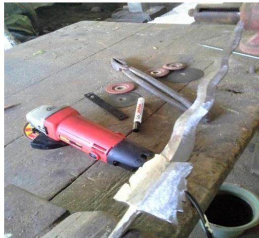
**Gambar 7.** Proses pembentukan bilah keris (Foto dan scan: Ari Harmawan: 15/10/2018)
