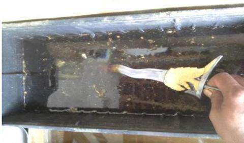
**Gambar 15.** Proses *ngamal* membuka pori-pori pada bilah keris (Foto dan scan: Ari Harmawan: 27/12/2018)
