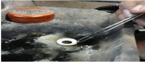
**Gambar 17.** Proses pemasangan butiran logam kuning (Foto dan scan: Ari Harmawan: 10/12/2018)
