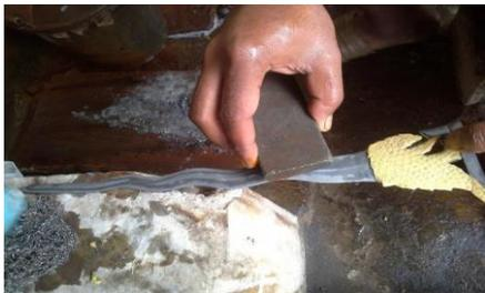
**Gambar 14.** Proses *nyangkling* pada permukaan bilah keris (Foto dan scan: Ari Harmawan: 27/12/2018)
