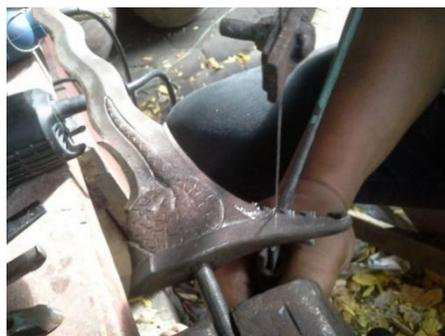
**Gambar 13.** Proses membuat *greneng* pada *ganja* (Foto dan scan: Ari Harmawan: 23/10/2018)
