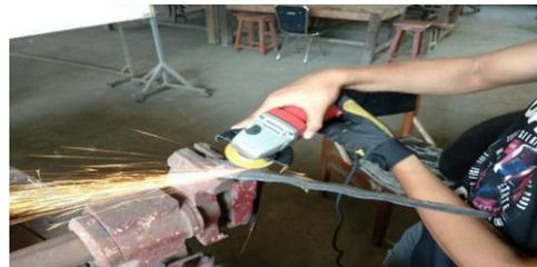
**Gambar 6.** Proses membersihkan permukaan bilah keris (Foto dan scan: Ari Harmawan: 15/10/2018)
