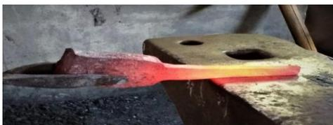
**Gambar 4.** Proses membentuk *kodokan* bilah keris (Foto dan scan: Ari Harmawan: 11/10/2018)
