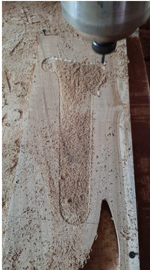
Proses pemahatan pola dasar warangka menggunakan mesin cnc router (Foto: Itok Dewanto, 2020)
