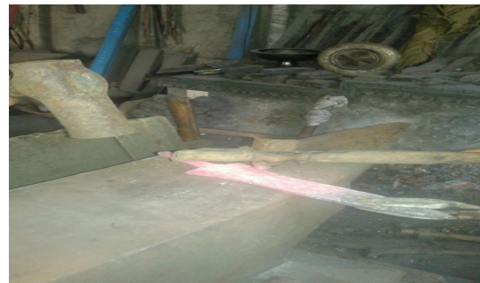
Proses nggedhegi menggunakan drip bulat (Foto: Itok Dewanto, 2020)
