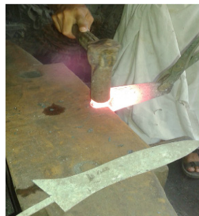
Proses memanjangkan pesi (Foto: Itok Dewanto, 2020)
