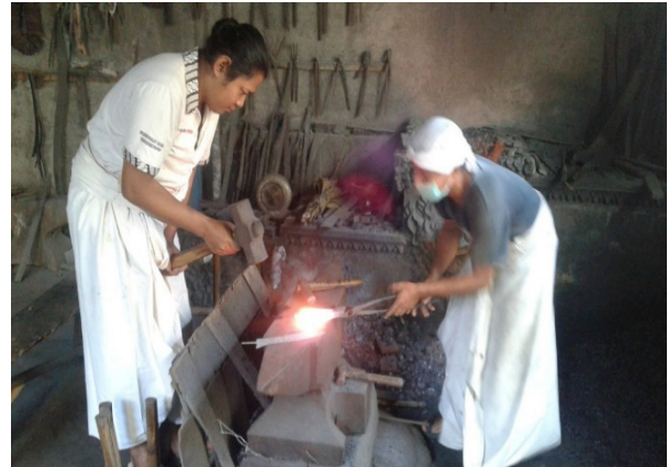
Proses pembentukan kodhokan (Foto: Itok Dewanto, 2020)
