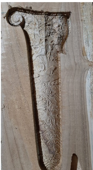
Hasil pemahatan motif warangka menggunakan mesin cnc router (Foto: Itok Dewanto, 2020)
